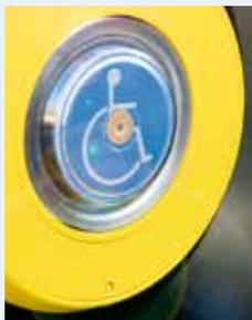
Lassen Sie sich Zeit: Nutzen Sie diesen Türöffner, um die automatische Türschließfunktion außer Kraft zu setzen. Damit bleibt Ihnen so viel Zeit, wie Sie zum Einsteigen benötigen. Unser Fahrpersonal schließt die Tür erst per Knopfdruck, wenn sich niemand mehr im Türbereich befindet.
